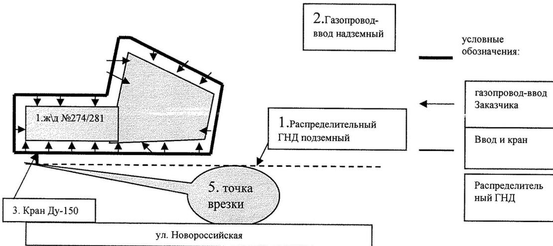
Условные обозначения: 1. Распределительный газопровод ; 2. Газопровод-ввод к жилому дому
